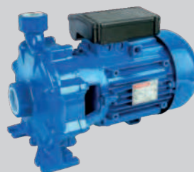
ELECTROPOMPE CENTRIFUGE C45 - 400V -1,85 KW - HTM 43 M - DÉBIT 125 L/MIN - EAU CHARGÉE
