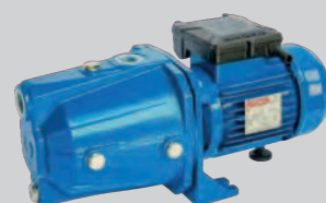
ELECTROPOMPE AUTO-AMORÇANTE CAM 152 - 400V - 1,5 KW - HTM 45 M - DÉBIT 150 L/MIN - EAU CHARGÉE
